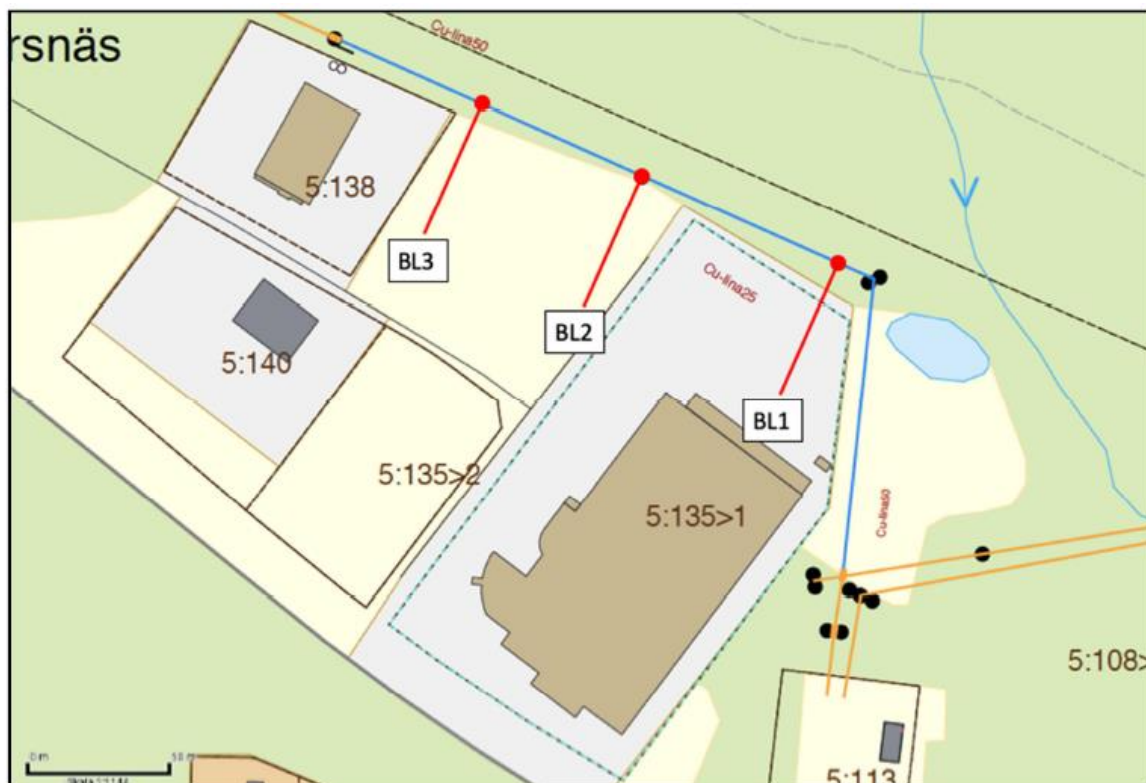
Bild 13. E.ON Energidistribution har utfört magnetfältberäkning avseende bidrag från E.ON Energidistributions 40 kV-ledningar, FÄN-FHAG-BYD och FÄN-FHAG vilka passerar intill kvartersmarken för industri. Resultatet av beräkningen återfinns i diagrammet nedan. Kurvan avser magnetsfältsnivån längs med linjerna BL1 – BL3 i figuren ovan och på en höjd av 1 meter över markytan.
