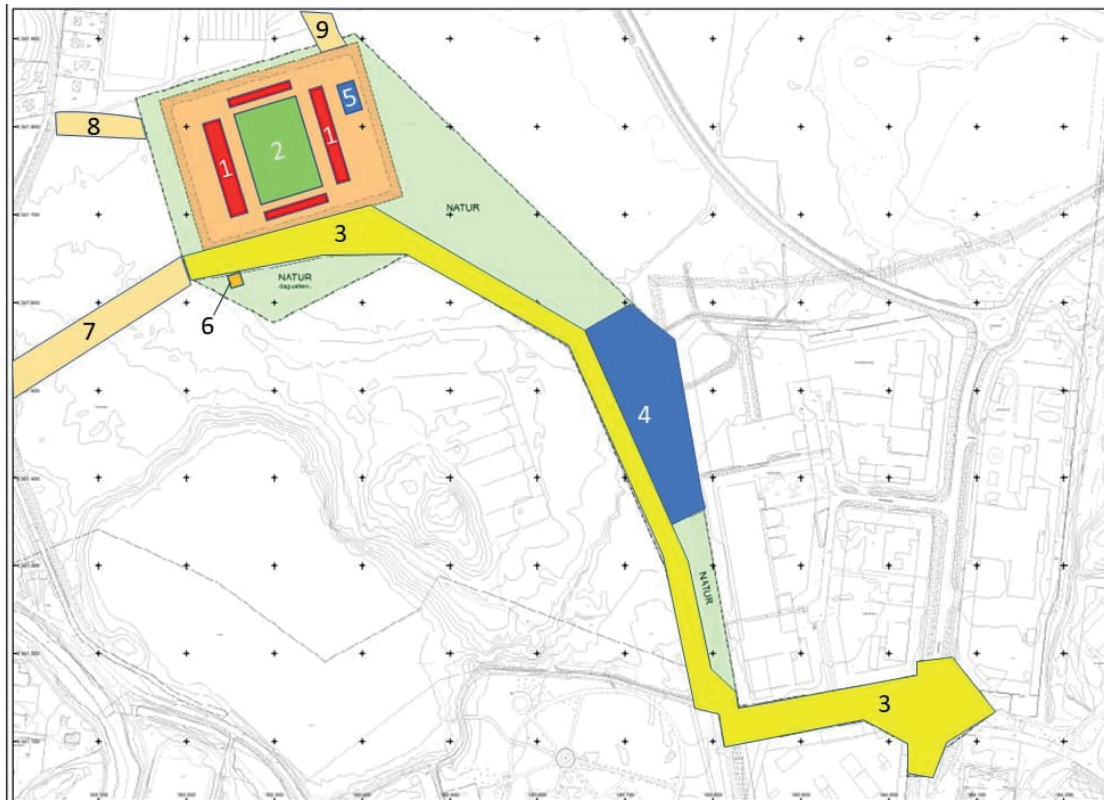
Figur 5. Förslagen utformning i detaljplan för fotbollsarena samt infartsväg. Anläggningsdelar. 1: Läktare, 2: Gräsplan, 3: Tillfartsväg, 4: Parkeringsytor. 5: Bevattningsdamm. 6: Pumpstation, 7: Byggväg, 8: Ledning för byggvatten och byggspill. 9: Överföringsledning från damm i tidigare lertäkt. Övriga ytor (ljusgröna): Natur.
