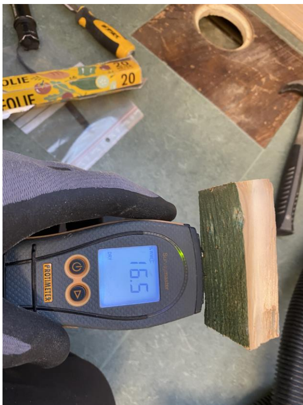
Foto 10, fuktmätning i uttagen provbit på plats.
