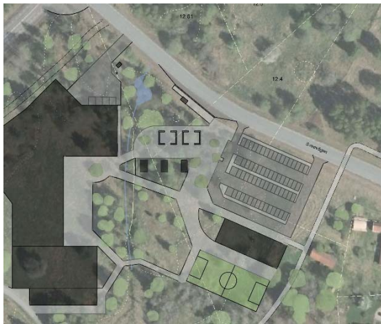
Situationsskissen visar på separat infart för varutransporter samt besöksparkering. Sammantaget visar skissen på cirka 70 parkeringsplatser för bil.
