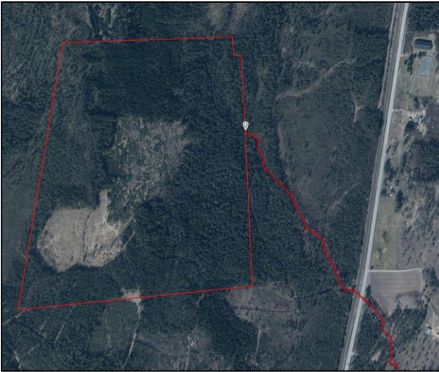
Figur 8. Flödesväg nedströms planområdet. Flödesvägen är uppskattad till 450 m till järnväg. Under järnvägen avleds dagvattnet med en 1200 mm trumma av betong, se Figur 9. Mittsektionen av trumman är en gammal fyrkantig stentrumma. Flödeskapaciteten ses som god.
