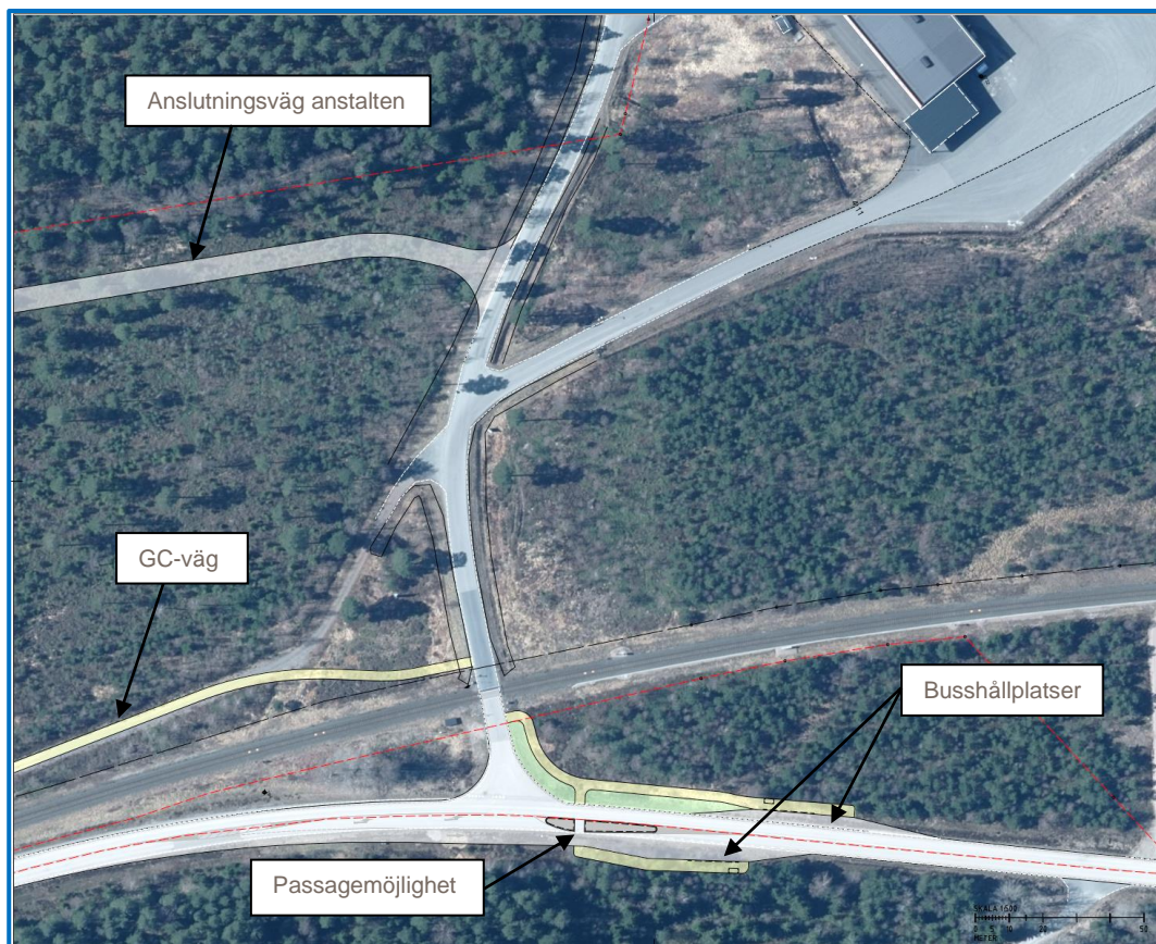
Bild 27. Korsningsutformning med vänstersvängfält och passagemöjlighet för de oskyddade trafikanterna av väg 846 och där befintlig korsning med järnvägen bibehålls.
