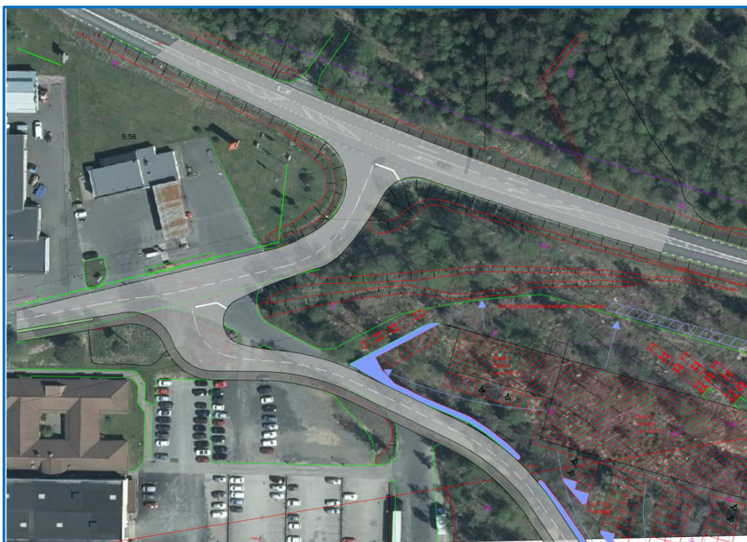
Bild 19. Förslag till utformning av korsningen Storgatan/ny anslutningsväg till det nya handels- och verksamhetsområdet och ny gång- och cykelväg.
