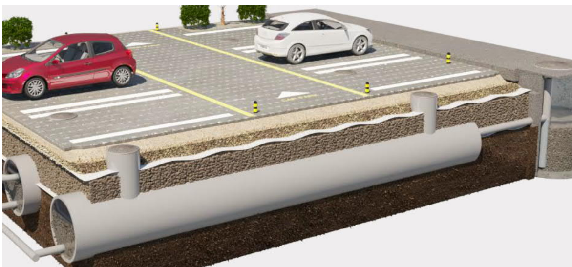
Figur 14. Exempel på fördröjning och rening i rörmagasin. Bildkälla: Wereco AB
