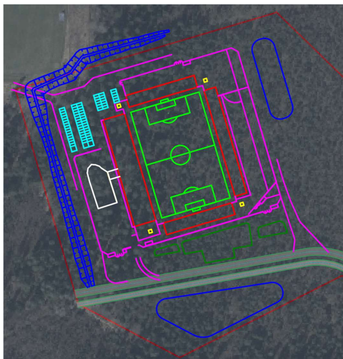
Figur 1.3. Förslagen utformning för fotbollsarena. Fotbollsplan i grönt, Läktare i rött, parkeringsplatser i ljusblått, dike samt dagvatten- och bevattningsdamm i mörkblått, belysningsstolpar i gult och entré i vitt (utformning enl. situationsplan, daterad 2022-10-21). Dagvattendammen i söder är struken.
