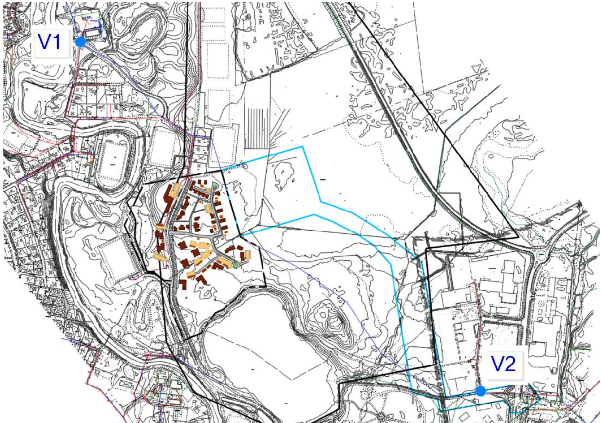
Figur 5. Två potentiella anslutningspunkter för vatten (V1 och V2). Här ses även ljusblå polygon för preliminärt planområde samt föreslaget bostadsområde. Dessutom ses, i mörkblå linje, en befintligt 400mm vattenledning.
