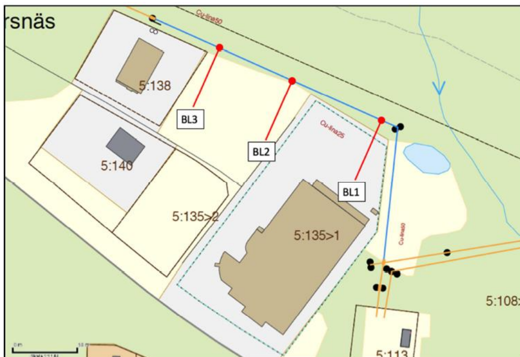
Bild 12. E.ON Energidistribution har utfört magnetfältberäkning avseende bidrag från E.ON Energidistributions 40 kV-ledningar, FÄN-FHAG-BYD och FÄN-FHAG vilka passerar intill kvarteretsmarken för industri. Resultatet av beräkningen återfinns i diagrammet nedan. Kurvan avser magnetfältsnivån längs med linjerna BL1 – BL3 i figuren ovan och på en höjd av 1 meter över markytan.
