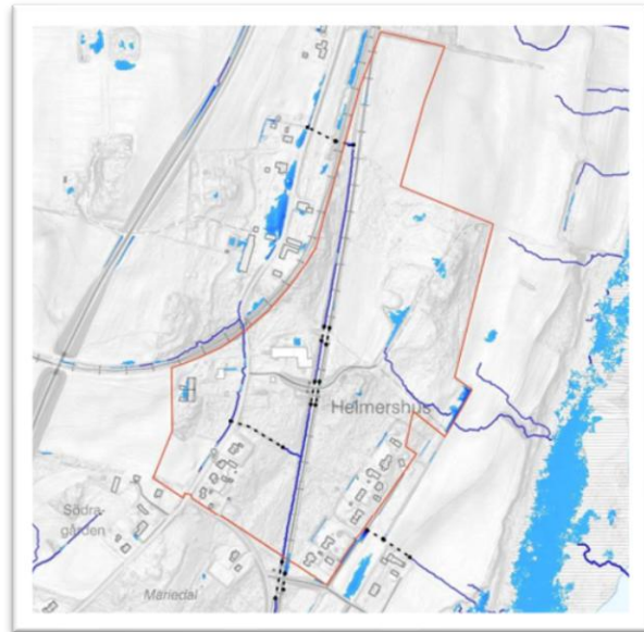
Figur 12, Skyfallsanalys. Blå ytor visar var vatten samlas vid 54 mm regn. Streckade linjer visar kulvert.
