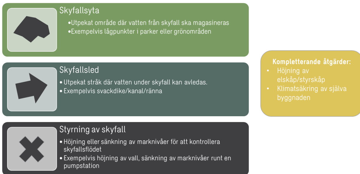
Figur 12. Schematisk illustration av tänkbara skyfallsåtgärder.
