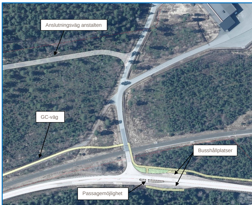
Bild 26. Korsningsutformning med vänster- och högersvängfält och passagemöjlighet för de oskyddade trafikanterna av väg 846 samt ombyggnad av korsningen med järnvägen.
