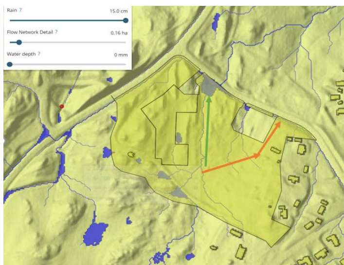
Figur 19. Förslag på omdirigering av skyfall. Grön pil: Befintligt stråk C. Orange pil: Föreslaget stråk.
