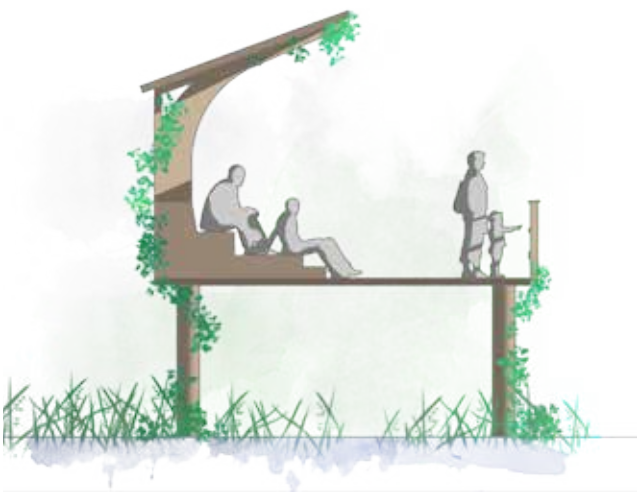
PRINCIPSEKTION AV BRO SOM OCKSÅ KAN FUNGERA SOM UTSIKTSPLATS/VÄDERSKYDD ELLER SCEN, SKALA 1:100.
