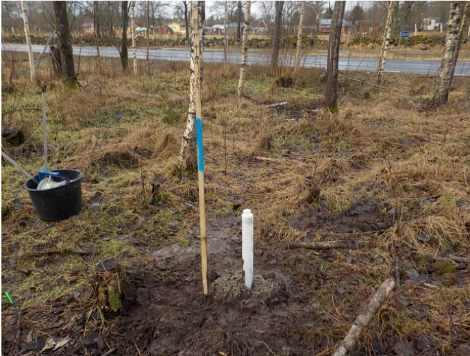
Grundvattenrör 2101, undersökningsområdets nordvästra del.
