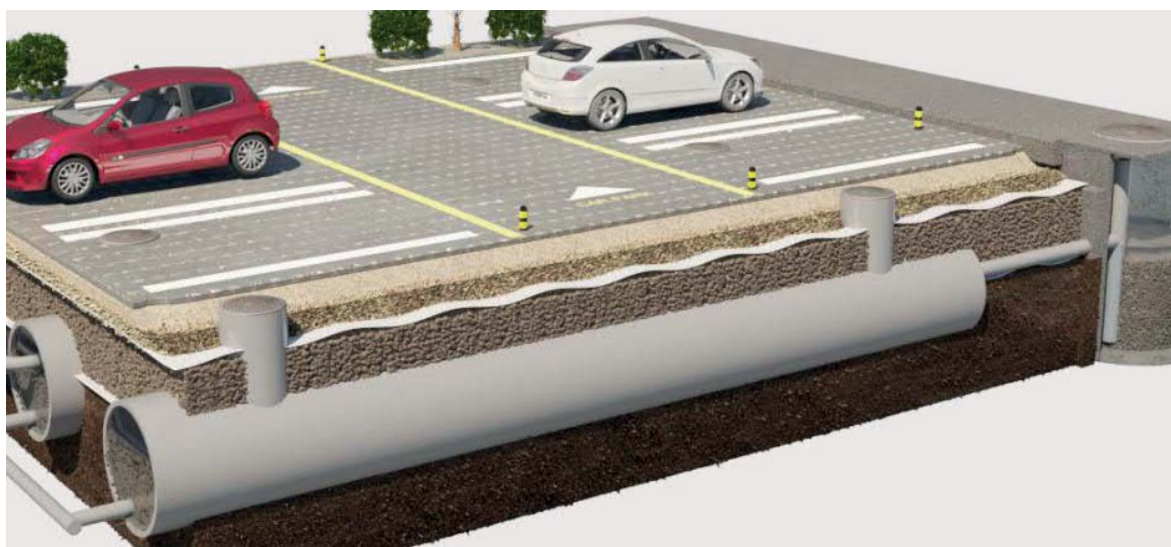
Figur 14. Exempel på fördröjning och rening i rörmagasin. Bildkälla: Weric AB
