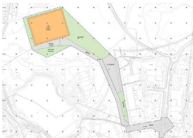
Figur 1.2. Förslagen utformning i Detaljplan för fotbollsarena samt tillfartsväg. Arenaområde markerat i orange, naturmark i grönt och tillfartsväg samt parkeringar i grått (Värnamo Kommun, Dnr. PLAN 2022.1568, daterad 2022-09).
