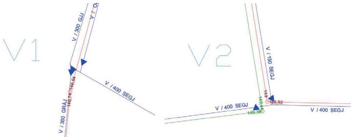
Figur 6. Detaljerade bild med dimension och ledningsmaterial vid anslutningspunkterna V1 och V2.
